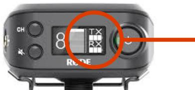
Zum Einschalten drücken Sie bitte 3 Sekunden den Ein-Aus-Knopf. Der Batterie-Status wird Ihnen anhand der 3-Balken Anzeige angezeigt.
